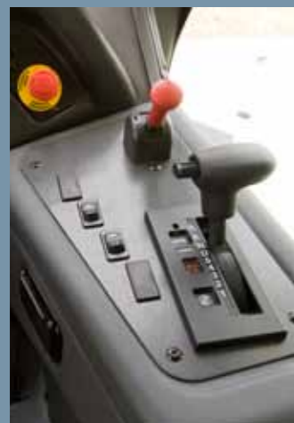
▲ Leva del cambio e freno di parcheggio Gear lever and parking brake
